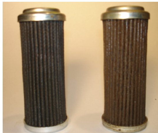
Saubere und verschmutzte Hydraulikfilter im Vergleich
